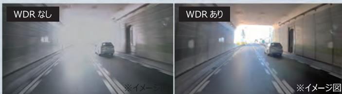
WDR(ワイドダイナミックレンジ)により、過度の露出や露出不足を補正し記録可能。トンネルの出口や薄暗い駐車場、夜間の撮影時に生じる黒つぶれや白とびなどを抑え、より鮮明でシャープな画像を記録します。
