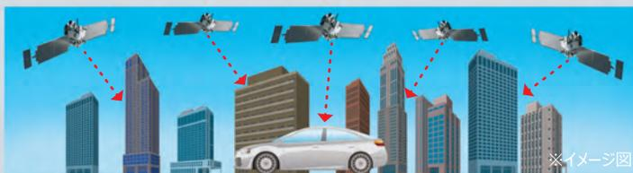
都市部や山間部ではビルや樹木などに電波が遮られて可視衛星数が減り、位置情報が安定的に得られないことがありました。みちびきは 4 機体制で運用しており GPS を補い、GPS と一体で利用できるため、安定した高精度測位を行うことを可能とする衛星数を確保することができます。より高精度で安定した位置情報を得る事により、録画データの位置や時間を正確に記録することが可能です。
